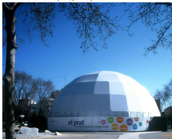
Media esfera monocapa recubierta con textil opaco, para exposición.
